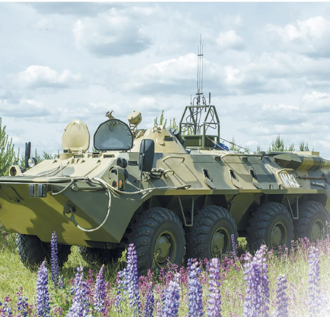
El inhibidor está diseñado para impedir la activación de artefactos explosivos radio controlados (RCEID) mediante generación de la señal en toda la franja de frecuencias operativas; se instala sobre el medio de transporte y sirve para protección contra RCEID en marcha o en modo de estacionamiento.
