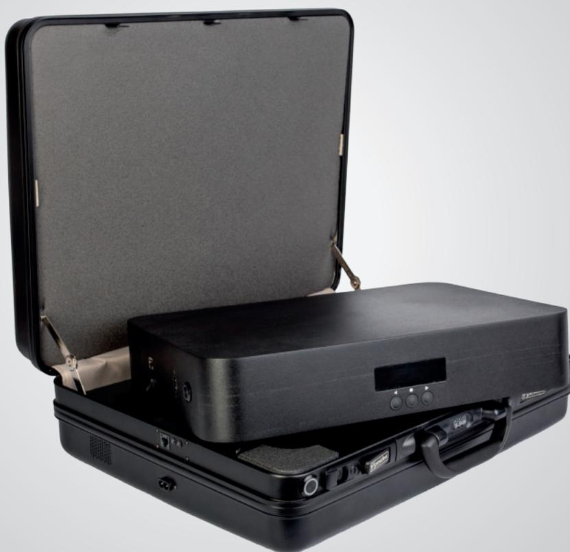
Изделие предназначено для интеллектуального и постоянного противодействия радиоуправляемым взрывным устройствам (РВУ) и для защиты от несанкционированного прослушивания с помощью специальных радио средств работающим в рабочем диапазоне частот изделия.
